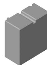
Obr. č. 7 Záslepka pro štěrbinový žlab
