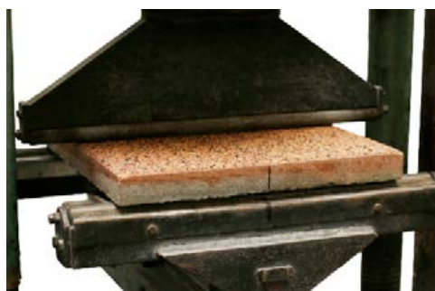
DLAŽBA PŘI ZKOUŠCE PEVNOST V DHYBU
