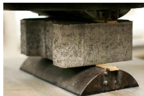
DLAŽBA PŘI ZKOUŠCE PEVNOST V PŘÍČNÉM TAHU
