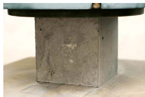
BETON PŘI ZKOUŠCE PEVNOST V TLAKU
