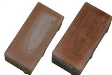
Povrch dlažby s vápenným výkvvětem před čistěním a po vyčistěním Rebanitem S
