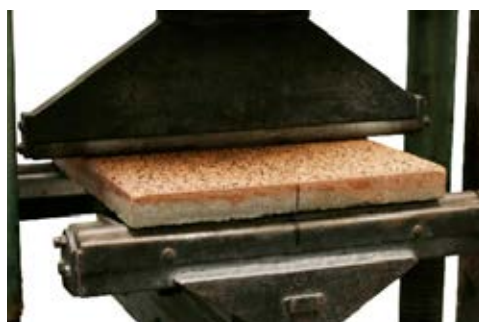
DLAŽBA PŘI ZKOUŠCE PEVNOST V DHYBU
