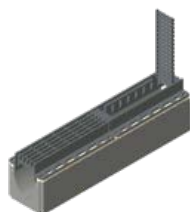
LITINOBETONOVÝ ŽLAB DN 150 - ČISTICÍ KUS Rozměry: 100 × 23,4 × 26,9 cm
